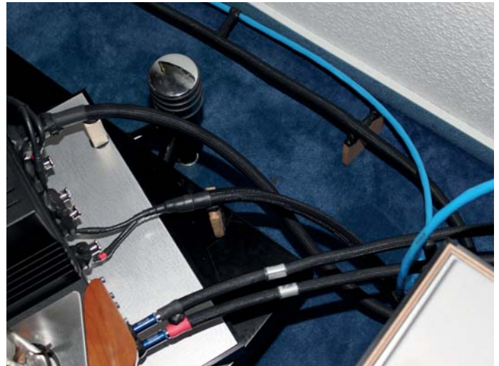
Die Abschirmung von Eingangsbuchsen und Kabeln mit Spezialknete soll klangbeeinträchtigende Vibrationen verhindern
